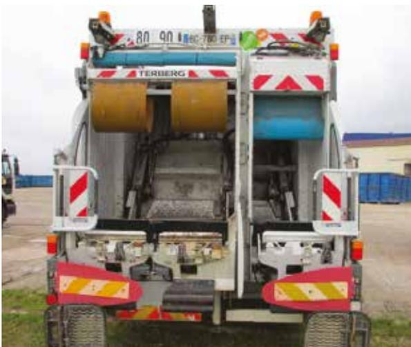
Avec la benne bi-compartimentée, un seul ramassage suffit pour les déchets triés et les ordures ménagères.
